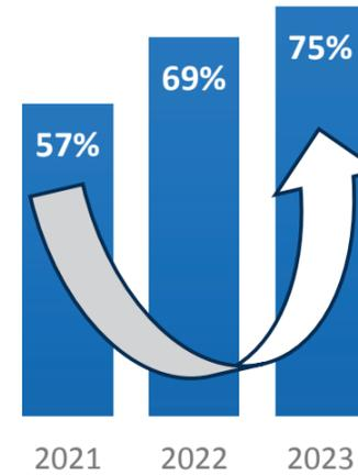
Le rendement brut correspond au ratio entre le volume d'eau consommé et le volume d'eau introduit dans le réseau de distribution. L'atteinte d'un taux de 100% est irréaliste cependant le SIEVAM s'est fixé comme objectif d'atteindre un rendement entre 80 et 90%.
